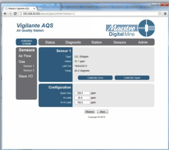
Cada Vigilante AQS™ cuenta con ocho puertos para la conexión directa de sensores digitales de flujo de aire, gas, presión, humedad e inclusive para módulos I/O remotos.
